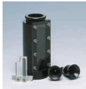
\* 各ホルダーセットにはチューブホルダー、ピストンチップ2ヶ、カーソル、Setonチューブ1箱が含まれています。
